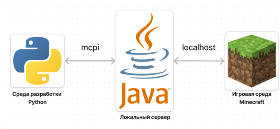
Рисунок 1. Схема подключения Python и Minecraft.
